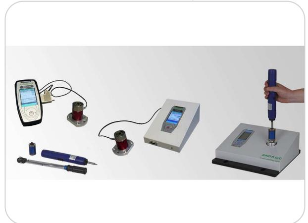
Mit der aktuellen Version der Centormeter-Geräte können Sie die Anzugsmomente von Akkuschaubern überprüfen. Dies betrifft elektrische, pneumatische und hydraulische Schrauber mit einer Drehzahl bis zu 3.000 U/min. Das Centormeter stellt die entsprechende Kurve dar. So kann der Anstieg des Drehmoments unmittelbar sichtbar gemacht werden. Die Drehmomentsensoren erlaubt genaue Messungen von 0-6 Nm bis zu 0-60 Nm.
