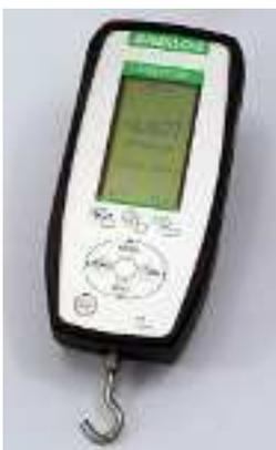
Die digitalen Kraftmessgeräte Centor Easy wurden entwickelt, um die Bedürfnisse der Anwender in der Produktion zu erfüllen. Sie verfügen über viele wesentliche Funktionen für die Qualitätskontrolle: **Gut lesbar dank großem hintergrundbeleuchteten Grafikdisplay, Speicherung der letzten 100 Werte, RS232-Ausgang und der Möglichkeit, Schwellenwerte mit visuellen und akustischen Alarmen zu programmieren.** Das M5-Gewinde auf der Rückseite des Centor macht die Montage auf Wiretest einfach.
