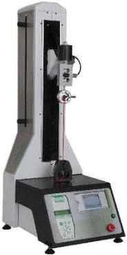
Mit dem Wiretest 2 ist die Messung der Reißkraft an Verbindungen eine einfache, schnelle und sehr repräsentative Messung des Crimpzustandes.
