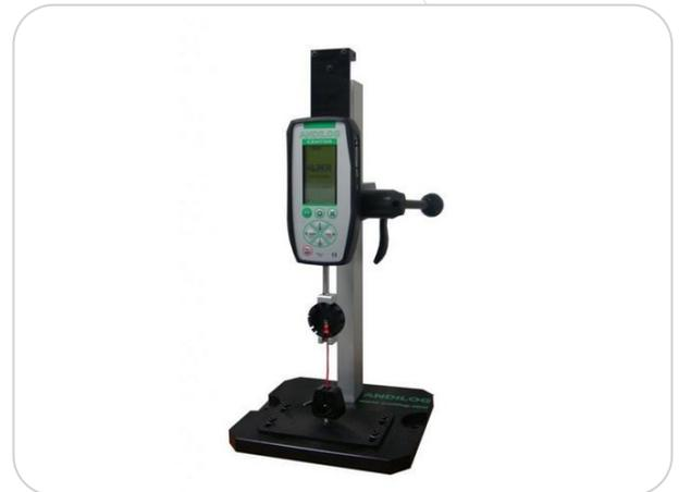
Sie können auch mit der Software Caligraph arbeiten, um die maximale Kraft deutlich auf dem Kurvenverlauf anzusehen und Ihre Ergebnisse zu vergleichen. Die Kurvenverläufe und die Messdaten (Bruchkraft, Mittelwert) können Sie in personalisierte Berichte exportieren.
