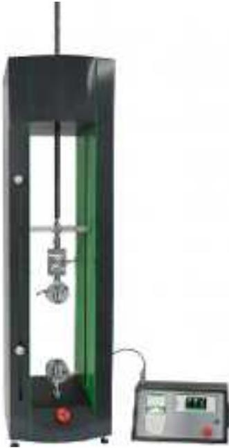
Der Wiretest 3 Prüfstand wurde entwickelt, um die Crimpqualität von Kontakten mit großem Durchmesser zu überprüfen.
