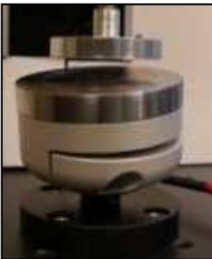
Bei der ersten und regelmäßigen Benutzung ist es notwendig die Parallelität zwischen der Druckplatte und der einstellbaren Stützplatte einzustellen.
