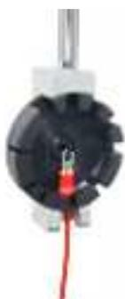
Das obere Montagesystem hängt von der Art der Crimpung ab, die Sie testen möchten. Standardmäßig sind die Wiretest mit einem Karussell ausgestattet, das es ermöglicht, mehrere Kerbenbreiten an unterschiedliche Kabelquerschnitte (**8 Kerben von 1,5 bis 6,3 mm Breite**) anzupassen.
