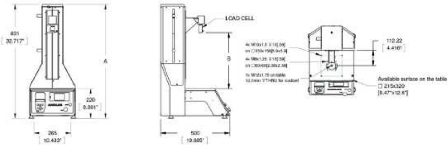
Abmessungen der Prüfstände
