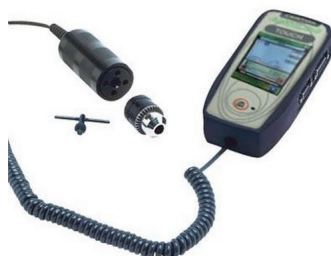
TH - Griffsensor mit Spannfutter
