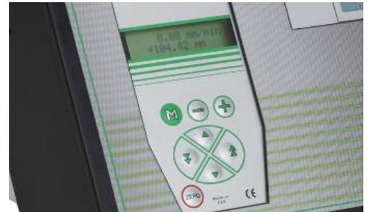
Die manuelle Motorsteuerung ermöglicht eine reibungslose Traversenverschiebung, um eine Position einzunehmen oder die ersten Tests zu justieren.
