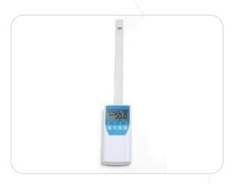
auswerten. Das Hygrometer wird additional mit Kalibrierstandards zur genauen Rekalibrierung im Betriebslabor versendet. Das Gerät ist hervorragend geeignet zur Ermittlung von Korrelationen zwischen absoluter Feuchte am Tambour der Papiermaschine und der relativen Feuchte im Papier auf der Palette oder im Lager.
