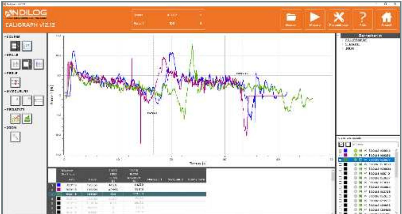
Die Centor Touch können mithilfe eines USB-Kabels an einen Computer angeschlossen werden. Mit der Datenerfassungs- und Analysesoftware Caligraph können Sie den Verlauf Ihrer Kraft-Zeit oder Drehmoment/Winkelkurven in Echtzeit ansehen, Ihre Daten speichern, Ergebnisse automatisch berechnen und personalisierte Testberichte erstellen.
