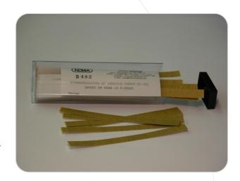
nach einer definierten Anzahl von Prüfzyklen (typischerweise 200 oder 500) gewechselt werden. Zu den Anwendungen gehören Glas- und Porzellanlacke, Farben, Metallbeschichtungen und Möbeloberflächen.
