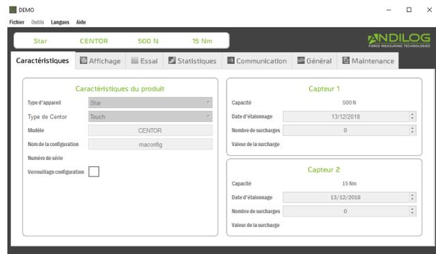
Die Software-Schnittstelle verwendet die gleiche Architektur wie das Centor Touch, um die Konfigurationsvorbereitung zu erleichtern. Alle Funktionalitäten sind auf dem PC verfügbar: Anzeige, Kurven, Grenzwerte, Ein-/Ausgänge..... Sie können jede Konfiguration benennen und speichern. Der **Name der Konfiguration wird beim Laden auf dem Centor-Touchscreen angezeigt**.
