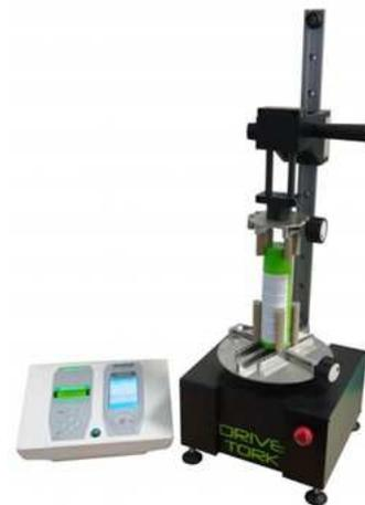
**Drivetork**, für automatisierte und wiederholbare Drehmomentmessungen
