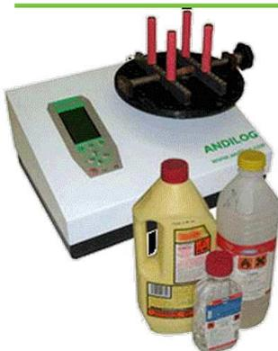
Das Anditork Dual wurde speziell für die Überprüfung des Öffnungsdrehmoments und der Druckkraft an Sicherheitverschlüssen entwickelt. Es verfügt über das gleiche Display wie die Star Version und **kann simultan den Kraft- und den Drehmomentsensor lesen**.
