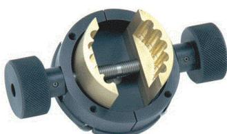
Diese Spannklemme wurde speziell für die Drehmomentmessung an Korken entwickelt.
