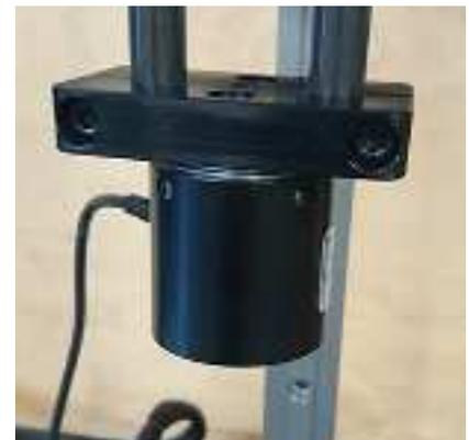
Die Finger und Platten ermöglichen unterschiedliche Flaschenhöhen, -Durchmesser und -Formen zu testen
