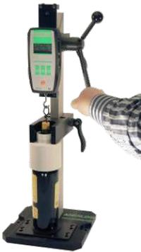
Der Extractor II ist ein einfaches und praktisches System, um die Zugkraft bzw. das Herausziehen von Korken schnell und mit großer Wiederholbarkeit zu messen.
