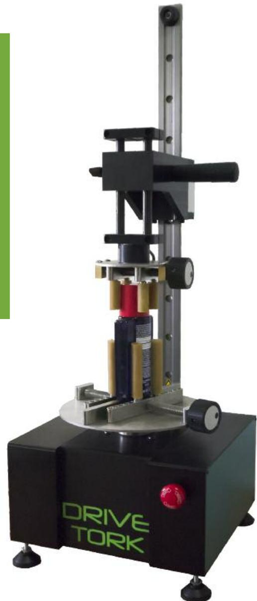
Um eine genaue und wiederholbare Messung durchzuführen ist es oft notwendig einen Drehmomentprüfstand zu benutzen, welcher eine einstellbare und konstante Geschwindigkeit gewährleistet.
