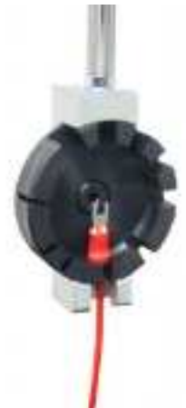
Wiretest 2 Automatisierte Überprüfung bis zu 5 kN
