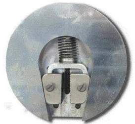
Selbstspannende Backe 50 kN
