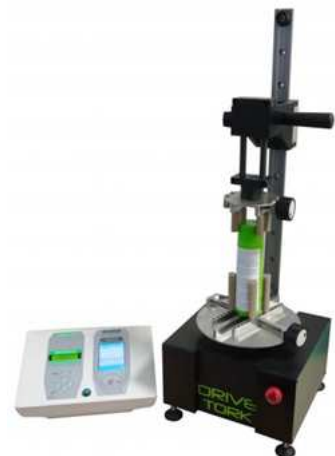
Drivetork , für automatisierte und wiederholbare Drehmomentmessungen
