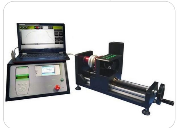
Der Drehmomentprüfstand ermöglicht die Durchführung von Tests mit verschiedenen Testproben wie Federn, Metall- oder Kunststoffprüflinge. Er besteht aus einem fixen horizontalen Gestell mit zwei Präzisionsführungsschienen. Das Gestell ist mit einem präzisen Drehmoment- und Winkelsensor ausgerüstet.
