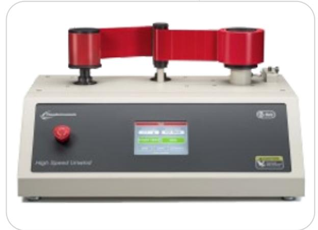
Das elektronische Datenerfassungssystem von ChemInstruments ist ein hochmodernes mikroprozessorgesteuertes Kraftmesspaket, das Genauigkeit und Benutzerfreundlichkeit vereint. Es steuert gleichzeitig die Testbewegung, liest die Kraft eines Tests aus einer Wägezelle aus, zeigt sie an und speichert diese Daten auch in seinem Speicher.
